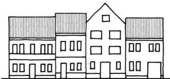
BILD 3 DER WECHSEL DER FIRSTRICHTUNG INNERHALB EINER GEBÄUDEZEILE STÖRT DIE HARMONIE. EIN WECHSEL DER FIRSTRICHTUNG IST DESHALB UNZULÄSSIG.
